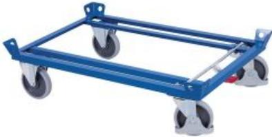
Dieser stabile Transportroller mit einer geschweißten Stahlkonstruktion ist mit einer Pulverbeschichtung in RAL 5010 blau lackiert. Der Wagen verfügt über zwei Schwenkräder und zwei feststehende Räder im Durchmesser 200x40mm und ist sehr wendig, stabil und einfach zu bedienen.
