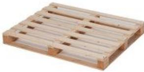
Diese gebrauchte, leichte Holzpalette aus mitteleuropäischem Fichtenholz mit sieben Deckbrettern, ist mit rundumlaufenden Kufen ausgestattet. Als hochfunktionale 4-Wege-Palette mit einer dynamischen Tragfähigkeit von bis zu 500 kg kann sie ganz leicht von allen Seiten mit einem Gabelstapler aufgenommen werden.
