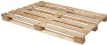
Diese gebrauchte mittelschwere Einwegpalette hat 7 Deckbretter, drei Zwischenbretter, neun Klötze und 3 Unterbretter. Bei einer Tragfähigkeit von 750 Kilogramm ist die Palette für mittelschwere Lasten geeignet
