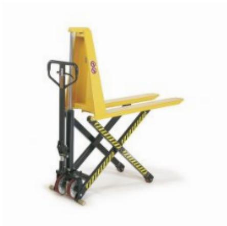
**Scherenhubwagen, pulverbeschichtet, 1000 kg, 1150x540mm**
